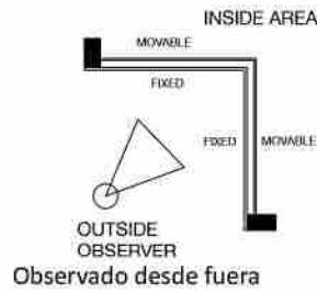
External corners 270° Équerres extérieurs (C-EXT) 270°
